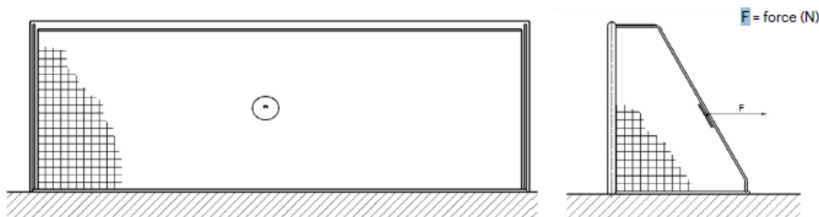
شکل ۱۳: محل اعمال بار بر روی تور برای دروازه‌های فوتبال تمام‌اندازه سوکتی یا متحرک (منبع: بند ۷.۳ استاندارد BS EN ۱۶۵۷۹:۲۰۱۸)
