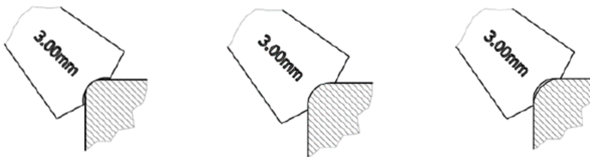
شکل ۲: شعاع انحنای منطبق، بزرگ‌تر از ۳۰۰ میلی‌متر شکل ۳: شعاع انحنای منطبق، دقیقاً برابر با ۳۰۰ میلی‌متر شکل ۴: شعاع انحنای غیرمنطبق، کمتر از ۳۰۰ میلی‌متر
